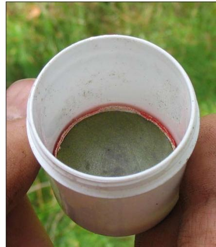
**Abbildung 5: offene Magnetdose mit fixiertem Markiermagnet**
