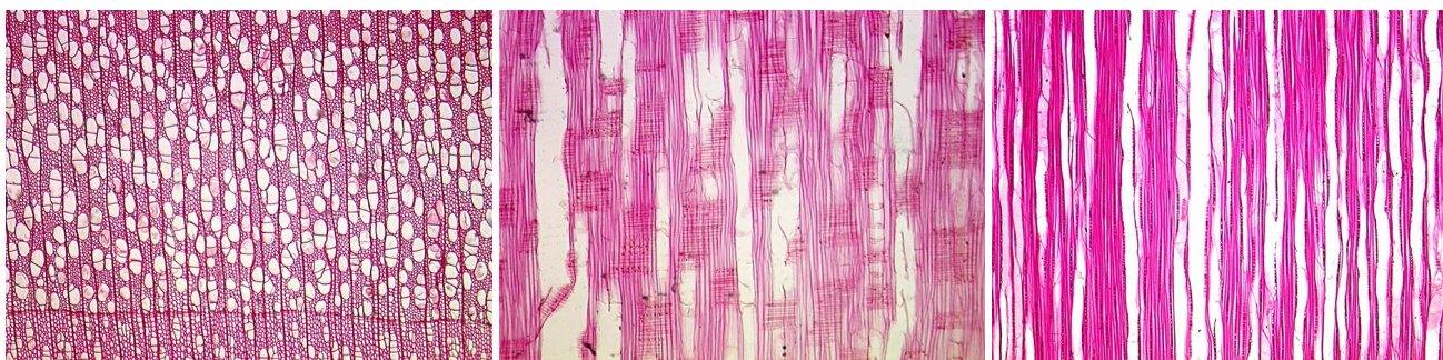
Obr. 2: Ukázka mikroskopické stavby dřeva topolu ( Populus sp.) – příčný, radiální a tangenciální řez
