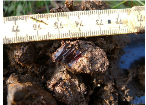
Foto 1: Die untersten Schichten der Bohrung 18: hoch zersetzte Feinseggen-Birkenbruchtorfe über sandiger Tonmudde über lehmigem Gneiszersatz.
