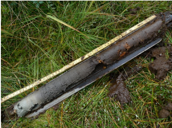
Foto 1: Die untersten Schichten der Bohrung 18: hoch zersetzte Feinseggen-Birkenbruchtorfe über sandiger Tonmudde über lehmigem Gneiszersatz.
