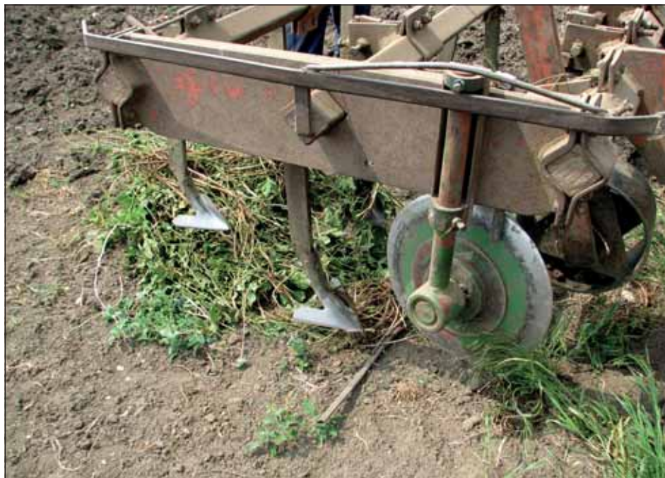
Pohled na talíř (krojidlo) plečky, omezující rozrůstání babky do meziřadí
