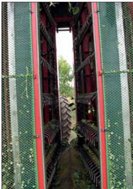
Detail česací stěny mobilního česače HUN-30
