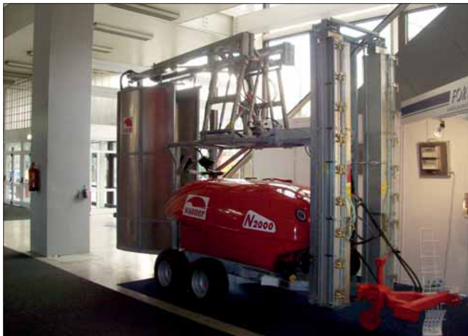
Tunelový postřikovač (rosič) v transportní poloze
