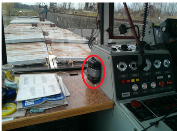
Obrázek 3: Připevnění OBU jednotky v kormidelně tlačného remorkéru TR17 při pilotním testování na trase 2 (Německo – Slovensko).
