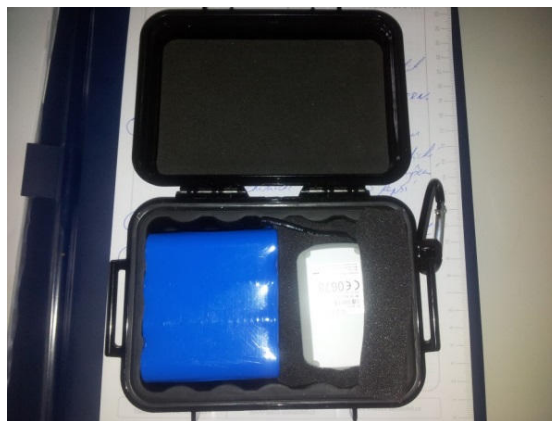
Obrázek 6: OBU jednotka použitá při pilotních testech na všech třech trasách. OBU jednotku tvoří tělo personaltrackeru s interní baterií (bílá barva) a záložní baterie (modrá barva).
