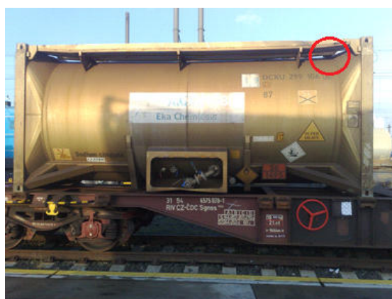
Obrázek 4: Připevnění OBU jednotky na cisternovém kontejneru společnosti NTR při pilotním testování na trase 2 (Německo – Slovensko).
