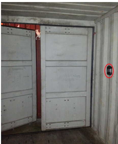
Obrázek 9: Upevnění OBU jednotky v uzavřeném kovovém 20' ISO kontejneru.
