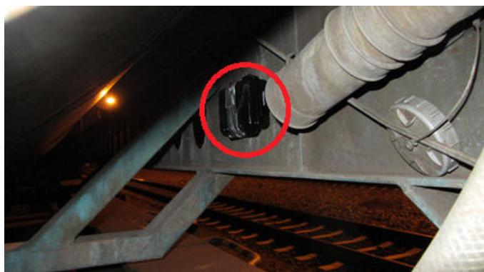
Obrázek 2: Umístění OBU jednotky na vnitřní straně rámu cisternového kontejneru společnosti LC Lauterbach Speditions-GmbH během pilotního testování na trase 1 (Německo – Ukrajina).
