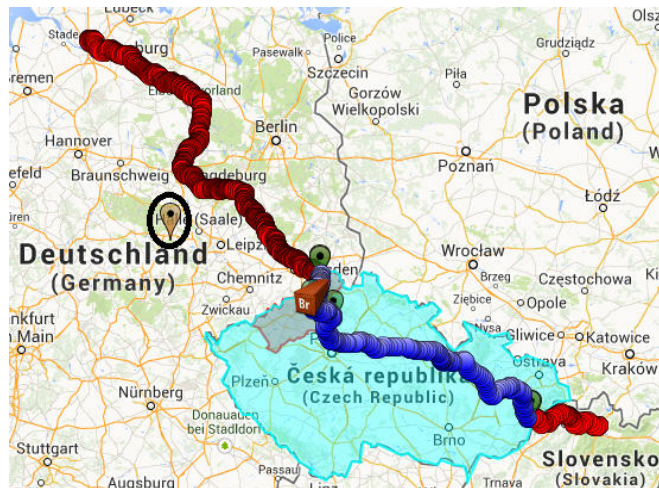
Obrázek 21: Nepřesnost měření polohy kontejneru od skutečné polohy (odlehlý bod).
