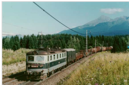
I v dnešních dnech pomáhají lokomotivy řady 183 (E 669.3) těžkým nákladním vlakům na postrcích na sklonově náročné „Štrbské rampě“ pod hřebeny Vysokých Tater.
