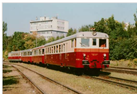
Motorové vozy řady 831 (M 262.1) se od strojů řady 830 (M 262.0) liší z vnějšího pohledu pouze minimálně. Rozdíl je v použitém spalovacím motoru a tedy i zvuku vozidla.
