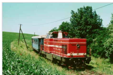
Technicky vylepšenou verzí lokomotiv řady 725 jsou vzhledově mírně odlišné stroje řady 726 (T 444.1).
