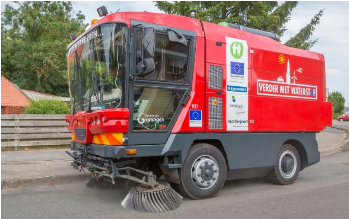
Obr. 3 Metařský vůz poháněný vodíkovým palivovým článkem používaný v Nizozemsku (3)
