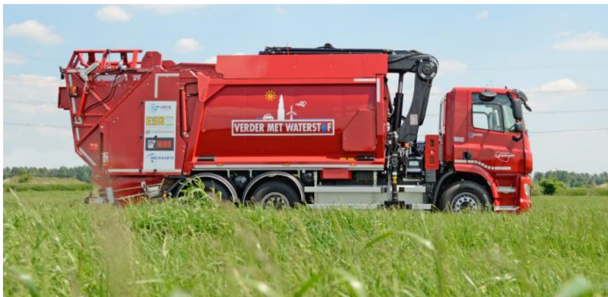
Obr. 4 Popelářský vůz poháněný vodíkovým palivovým článkem používaný v Nizozemsku (4)
